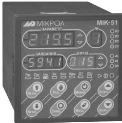
Рисунок 3.11 - Загальний вигляд контролера МІК-51
