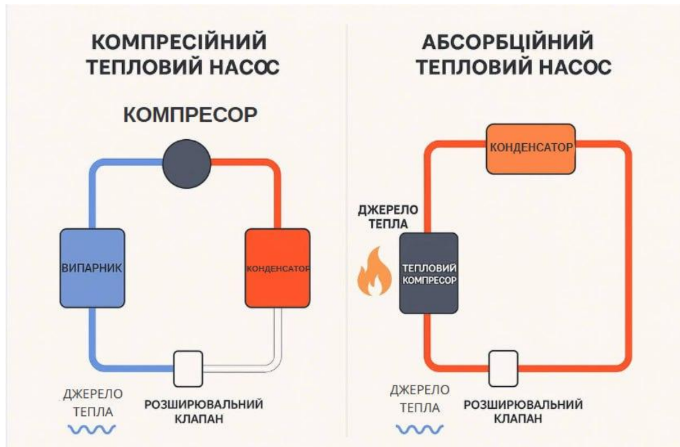
Рисунок 1.2 - Порівняльна схема роботи компресійного та абсорбційного ТН
