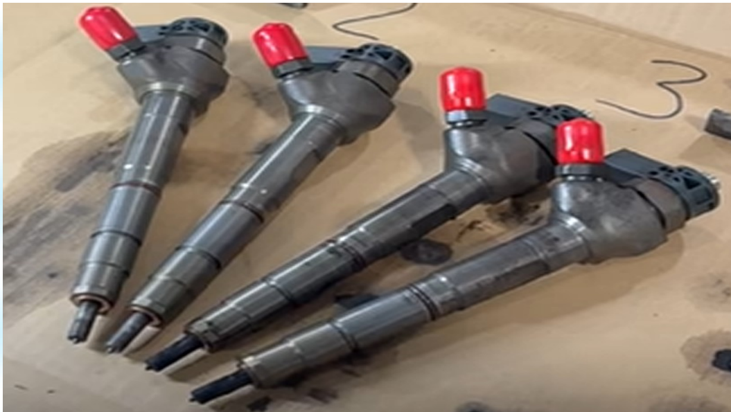
Рисунок 3 – Дизельні електромагнітні форсунки після (форсунки 1, 2) та до (форсунки 3, 4) очищення
