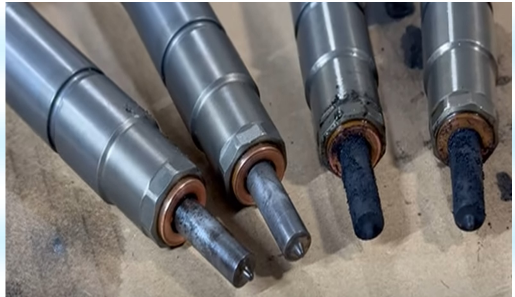
Рисунок 3 – Дизельні електромагнітні форсунки після (форсунки 1, 2) та до (форсунки 3, 4) очищення
