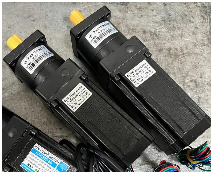
Рисунок 2.22- Двигун NEMA 23 та редуктор 1:6
