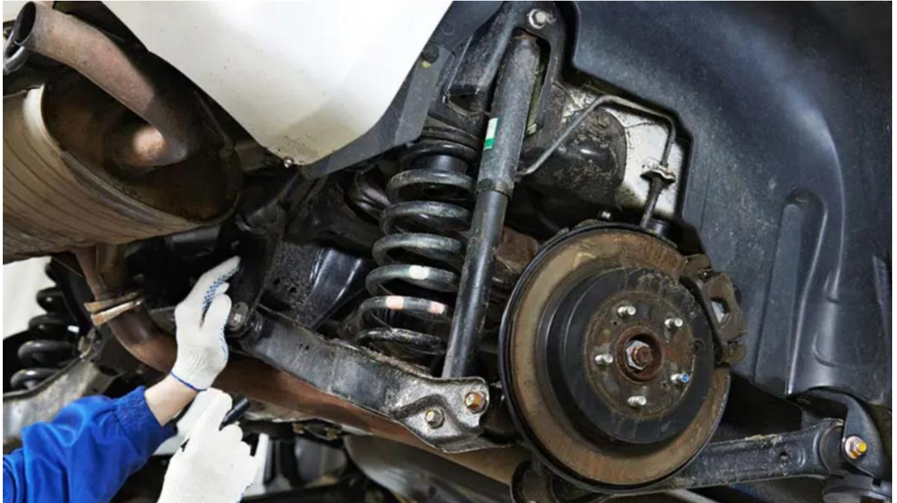
Рисунок 1.3 – Діагностика задньої підвіски автомобіля
