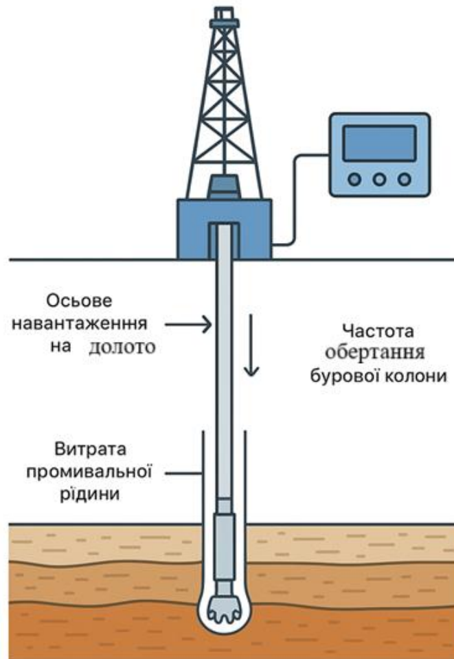
Рис.1.4. Основні технологічні параметри процесу буріння, що підлягають автоматичному регулюванню
