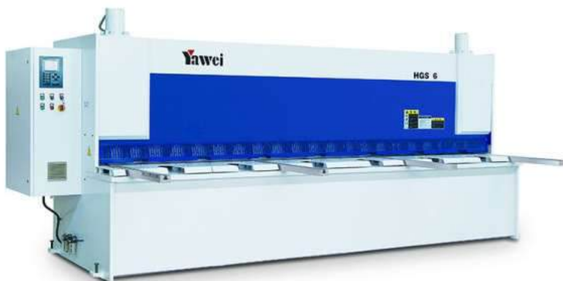
Рисунок 2.4 - Ножиці гільйотинні з чпк YAWEI HGS(K)-8
