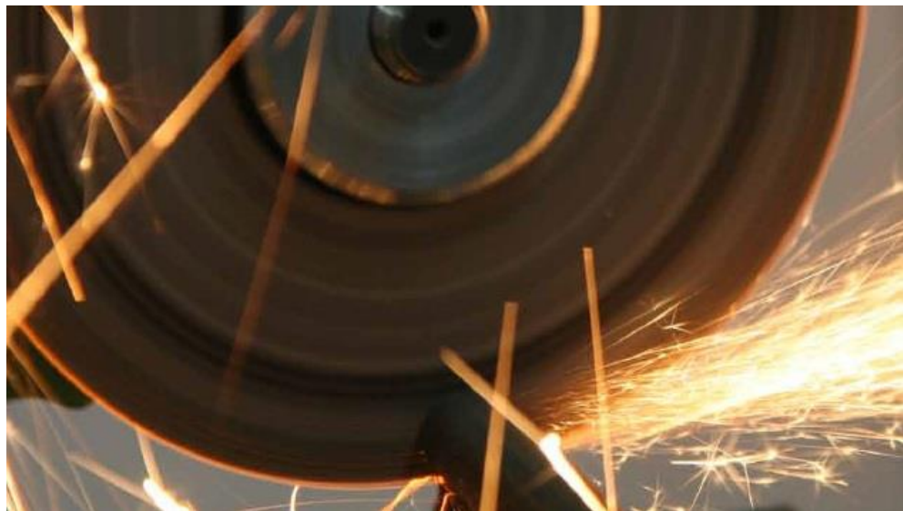
Рисунок 2.5 – Абразивне різання на монтажних пилах
