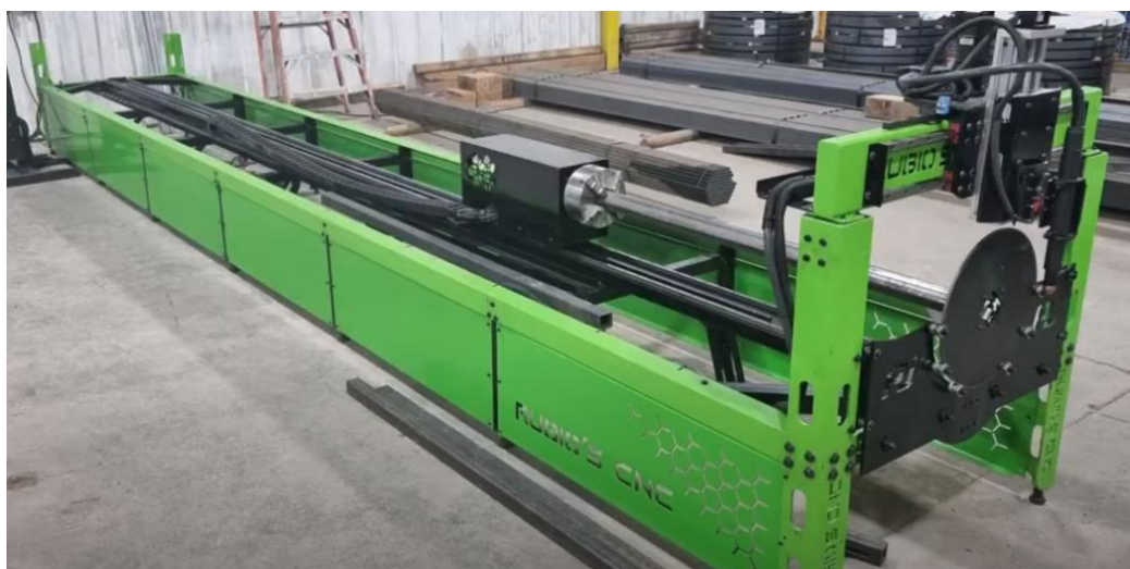
Рисунок 3.3 – Верстат плазмового різання профільного прокату RUBIOS CNC Rotary D4
