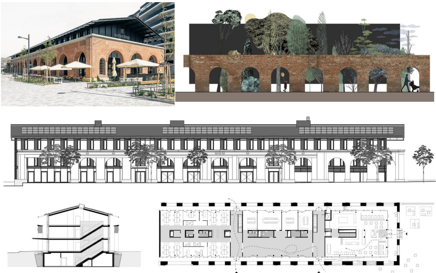
Рис.9. Фасади, плани та розріз коворкінгу GON Conversion Gösserhalle
