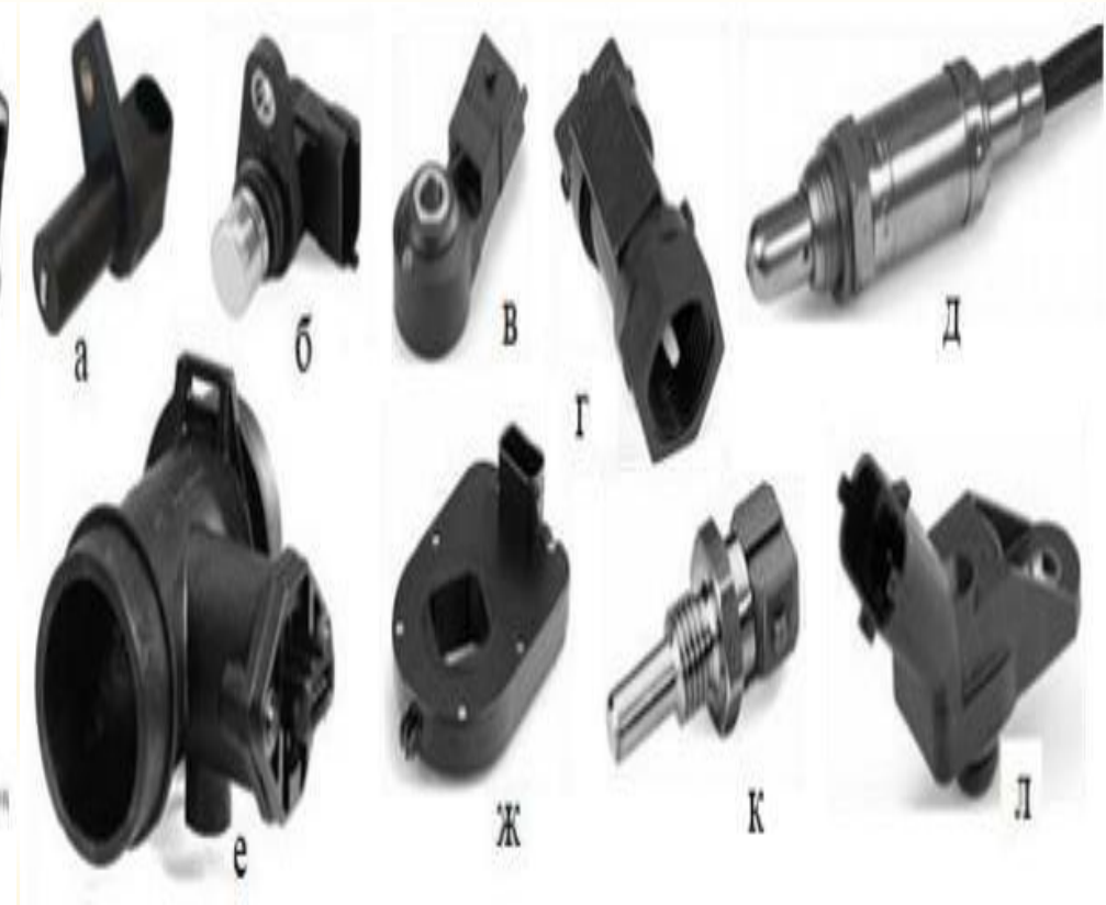
Рисунок 2.2 – Електронні елементи підсистеми подачі палива двигуна з ЕБК: а – давач кількості обертів колінчастого валу; б – давач розподільчого валу; в – давач детонації; г – давач швидкості руху транспортного засобу; д – давач кількості кисню; е – давач кількості повітря у впускній магістралі; ж – давач положення дросельної заслінки; к – давач температури двигуна; л – давач вакууметричного тиску у впускній магістралі
