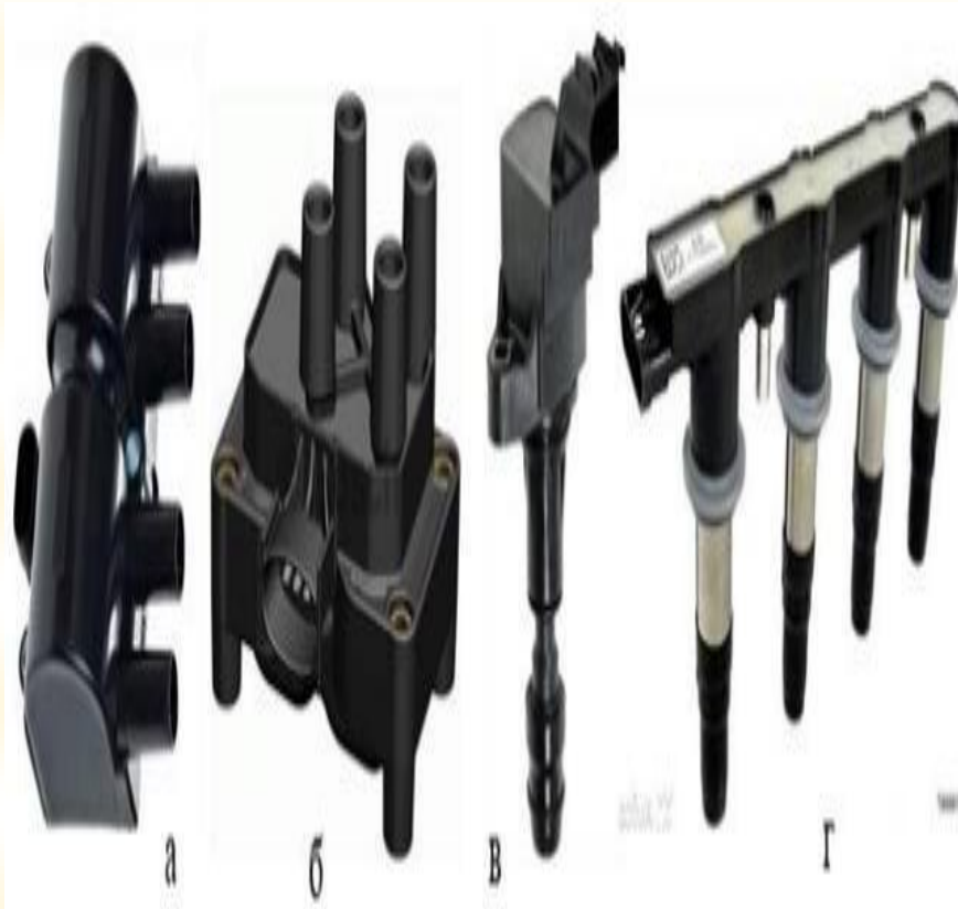
Рисунок 2.1 – Електронні елементи підсистеми запалювання двигуна з ЕБК: запалювання для сучасних ДВЗ: а – модуль дистанційного запалювання; б – двовиводні DIS-котушки; в – індивідуальні котушки для COP-систем; г – інтегровані індивідуальні котушки запалювання.
