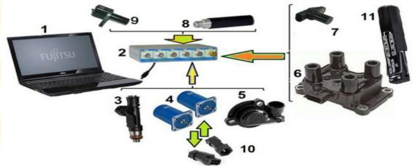
Рисунок 4.1 – Діагностичне обладнання та електронні елементи, що впливають на зміну кута випередження запалювання: 1 – діагностичний комп'ютер; 2 – осцилограф; 3 – електромагнітна форсунка; 4 – тахогенератори; 5 – датчик положення дросельної заслінки; 6 – котушка запалювання; 7 – датчик розподільчого валу; 8 – датчик тиску газів у циліндрі; 9 - датчик положення колінчастого валу; 10 – датчик швидкості; 11 – струмові кліщі
