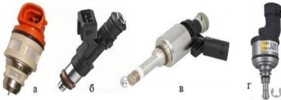
Рисунок 1.4 - Паливні форсунки різного типу впорскування [13]: а – центральні; б – розподільні; в - безпосередні; г – для подачі газу.
