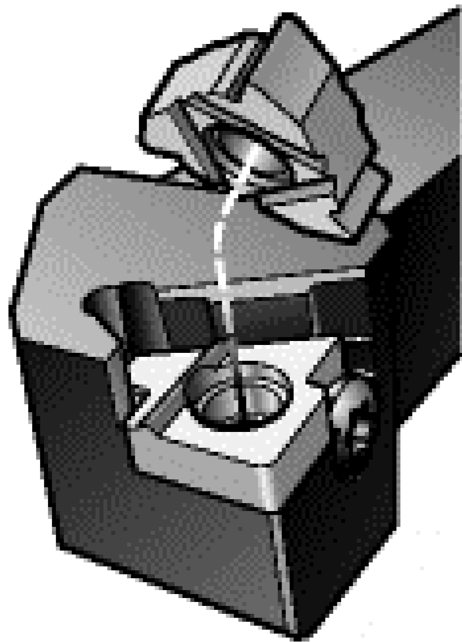
Рисунок 3 – Встановлення робочої різальної пластини на підкладну пластину
