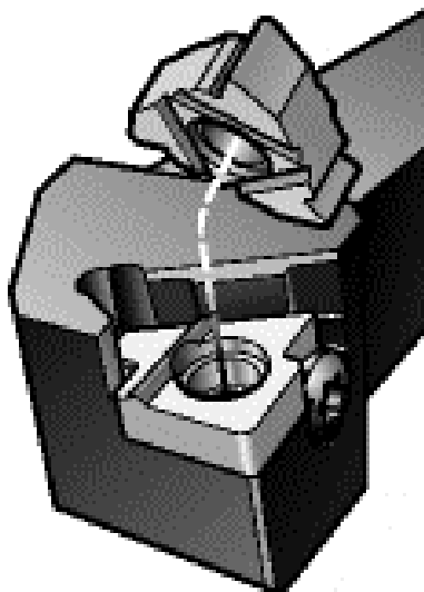
Рисунок 15 – Встановлення робочої різальної пластини на підкладну пластину
