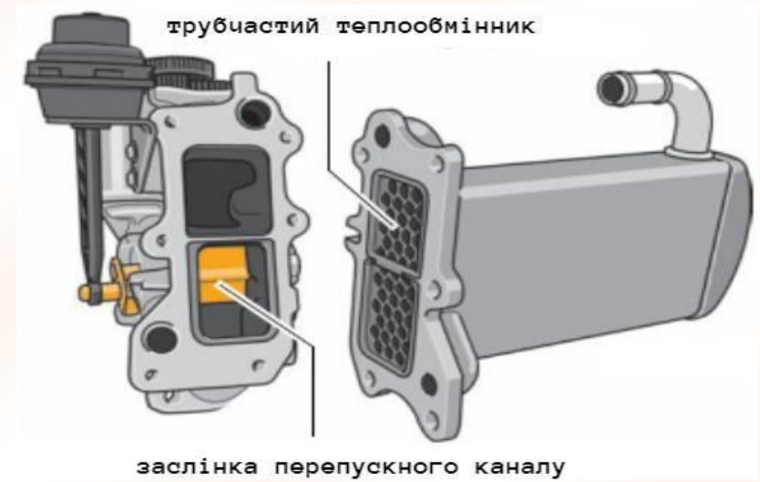
Рис. 7.2 – Клапан системи рециркуляції відпрацьованих газів ДВЗ ССНА
