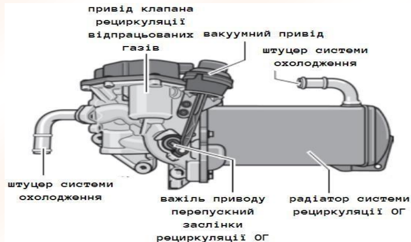
Рис. 7.3 – Модуль масляного радіатора із вбудованим радіатором системи рециркуляції
