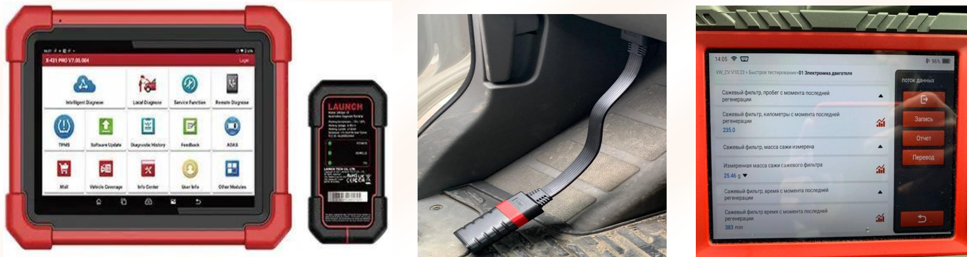
Рисунок 8.1 – Діагностика двигуна автомобільним сканером LAUNCH X-431 PRO SE V
