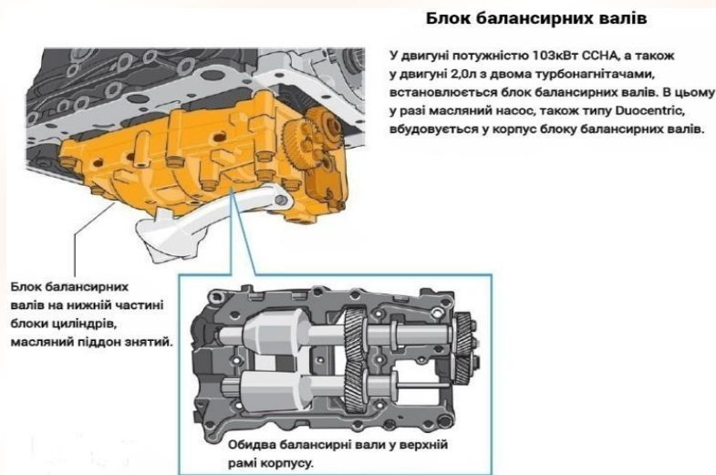
Рис. 6.3 – Блок балансірних валів двигуна ССНА
