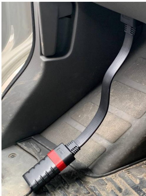
Рисунок 5.6 – Підключення сканера до автомобіля MAN TGE
