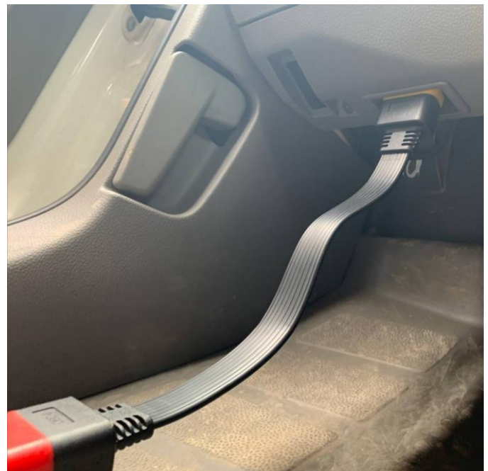
Рисунок 5.6 – Підключення сканера до автомобіля MAN TGE
