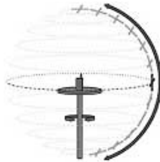
Рисунок 2.3 – Ілюстрація методу конічної секції для вимірювання 3-D діаграми спрямованості антени
