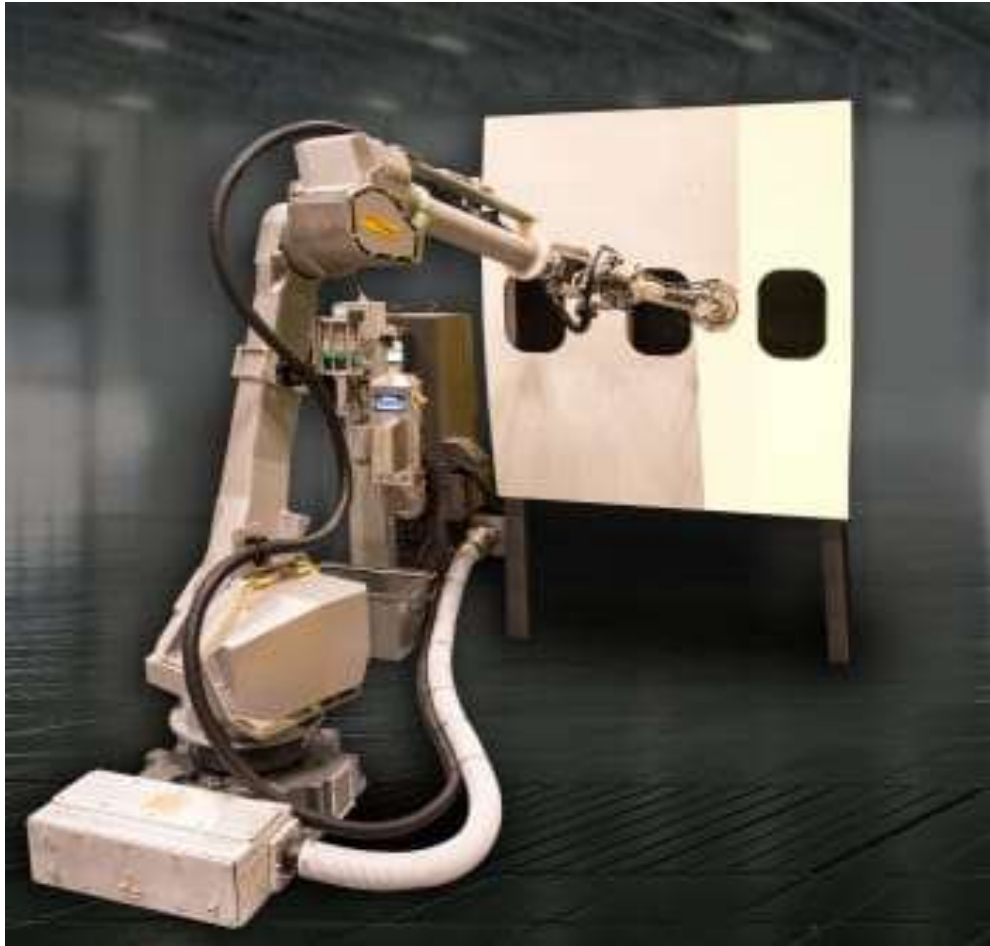
Рисунок 2 Робот електростатичним розпилювачем.
