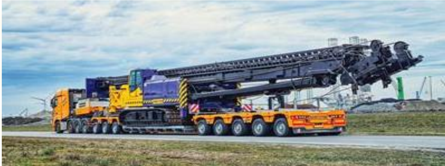
Рисунок 5.1 – Перевезення мобільної бурової установки на низькорамному тралі-напівпричепі
