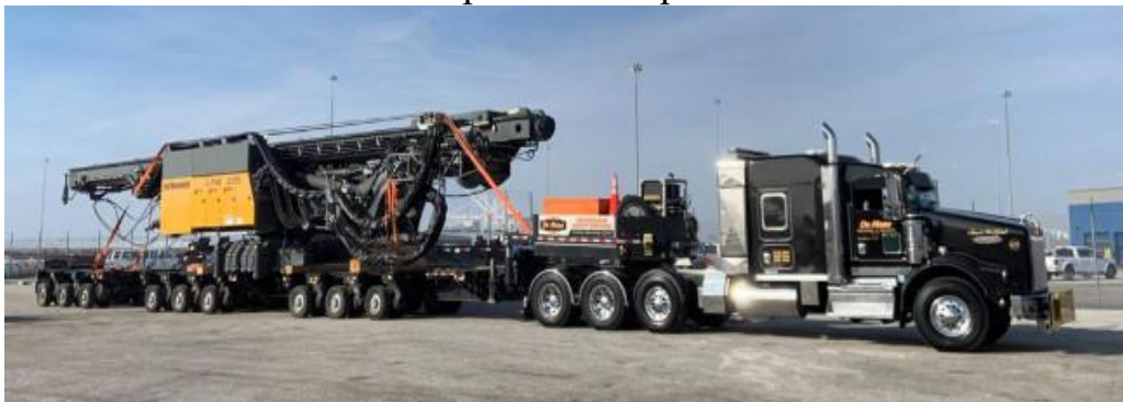
Рисунок 2.7 – Перевезення мобільної бурової установки на триланковому причепі
