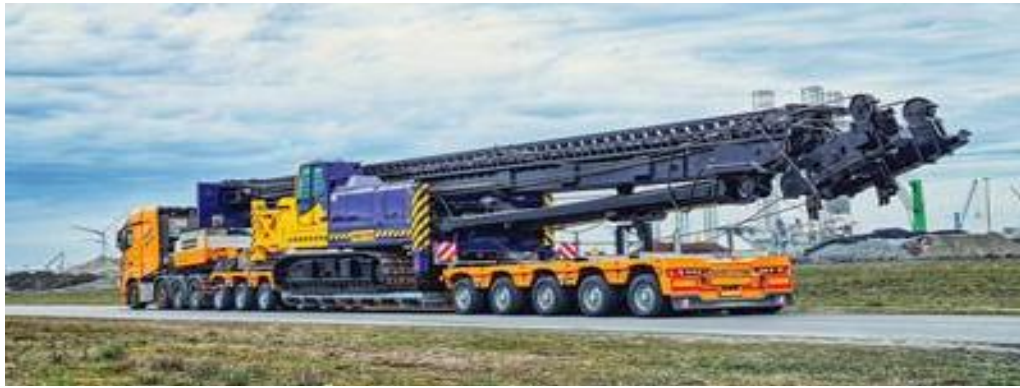
Рисунок 2.6 – Перевезення мобільної бурової установки на низькорамному тралі-напівпричепі
