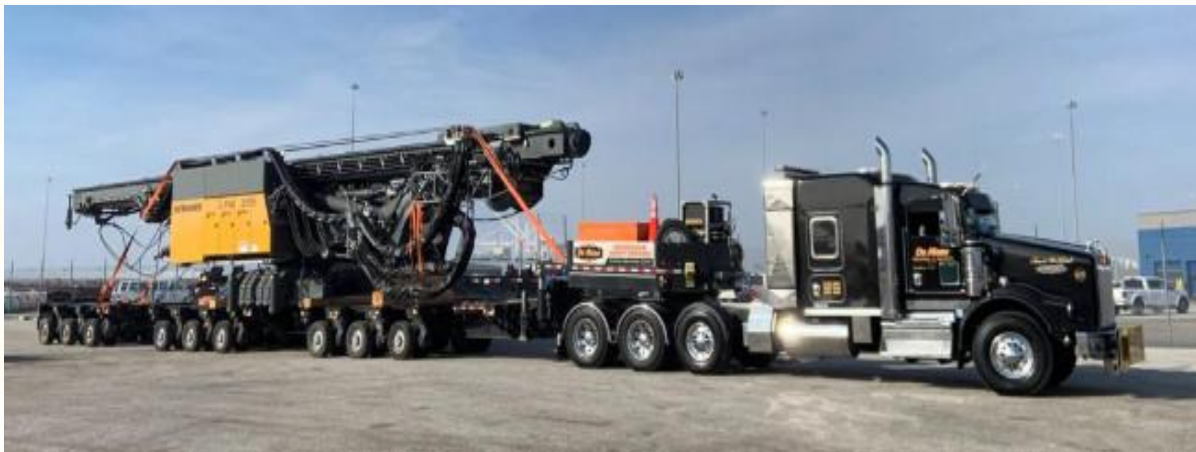
Рисунок 5.2 – Перевезення мобільної бурової установки на триланковому причепі
