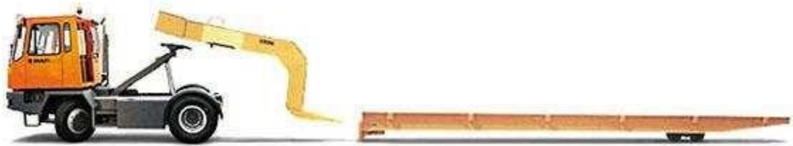
Рисунок 1.1 – Використання гузнека для зчеплення тягача з низькорамним тралом
