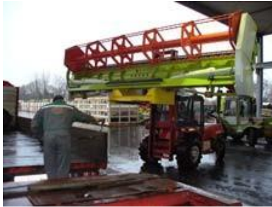
Рисунок 3.15 – Автонавантажувач FG10T19 при навантаженні
