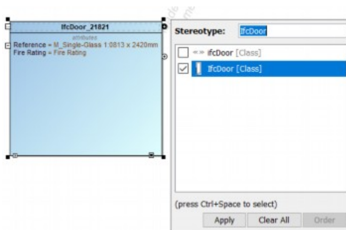
Рис. 3.11. Застосування IfcDoor_21821 до конкретного стереотипу; <<IfcDoor>>
