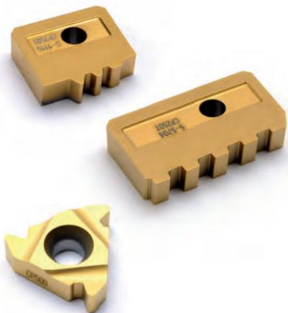
Рис. 2.1 – твердосплавні вставки для велико-крокових нарізей: три-ниткова гребінка для нарізі з трикутним профілем, п'яти-ниткова гребінка для нарізі трапецеїдального профілю, звичайна три-змінна пластина для замкової нарізі.
