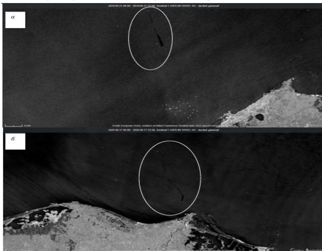
Рисунок 2.6 — Виявлення розливів нафтопродуктів на водній поверхні за радіолокаційними знімками супутника Sentinel-1 [20]
