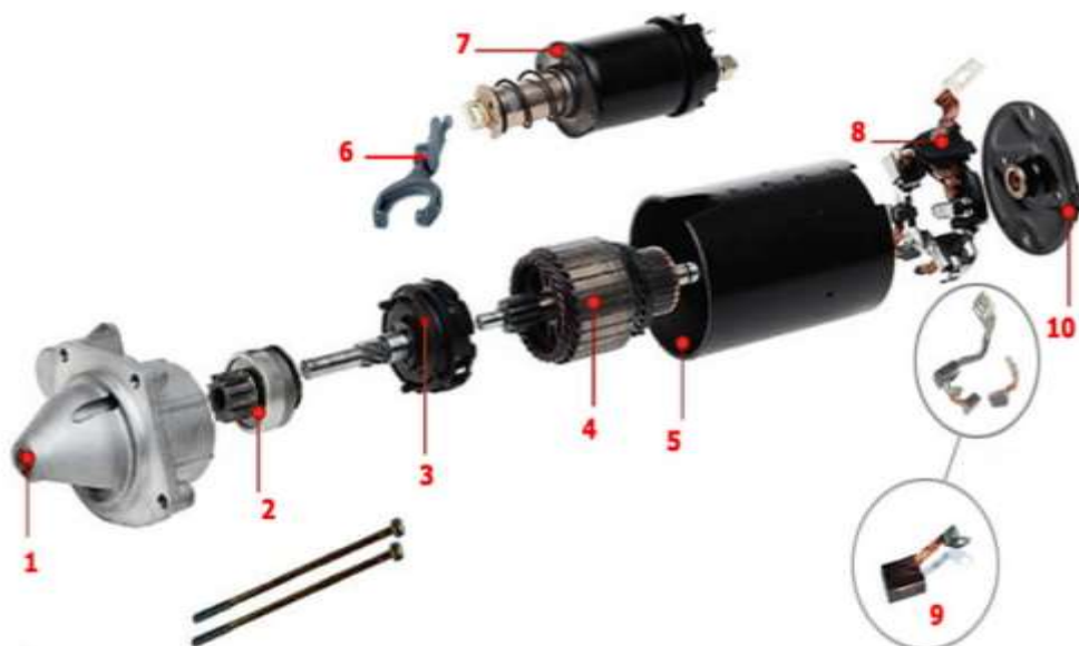
Рисунок 6.3 Стартер автомобільний: 1. передня кришка; 2. бендікс; 3. редуктор; 4. якір; 5. корпус статора в зборі; 6. вилка; 7. втягуюче реле; 8. щітковий вузол; 9. щітки; 10. задня кришка стартера автомобіля.
