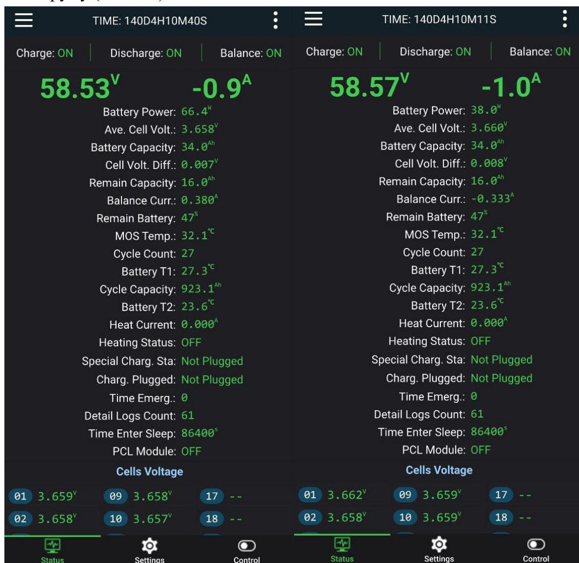
Рисунок 3.5 – зображення балансування струмом в програмі JK BMS
