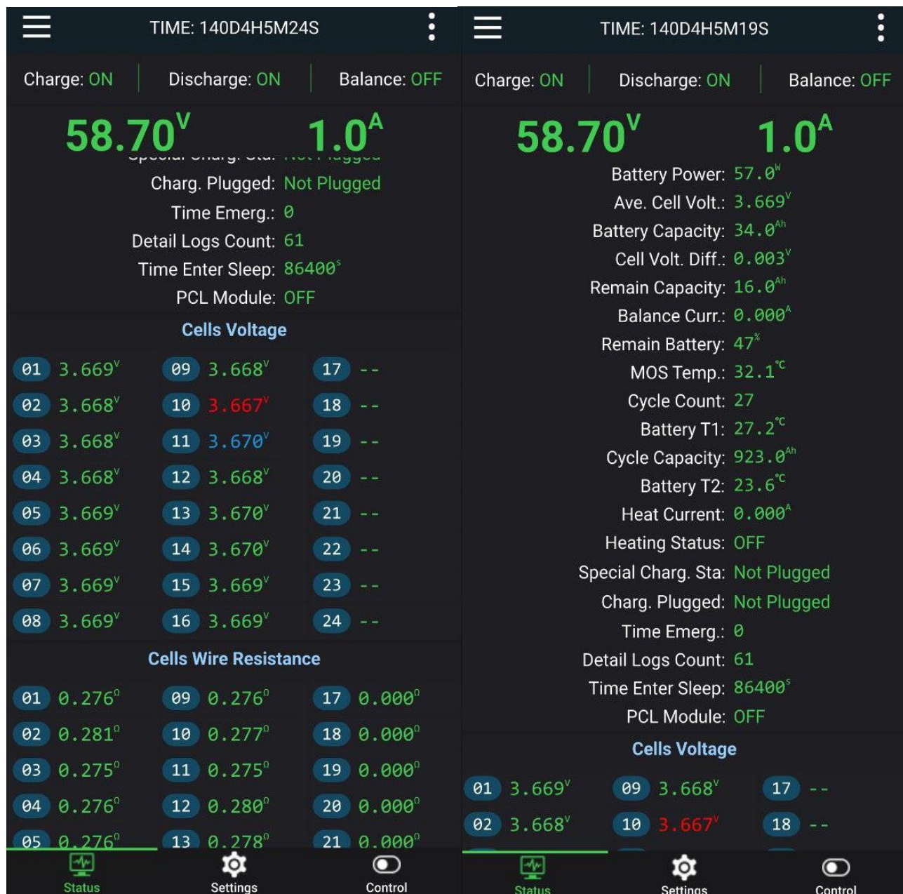
Рисунок 3.4 – розділ «Статус» в додатку JK BMS з зображенням характеристик АКБ
