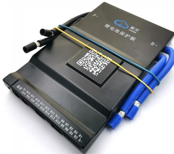
Рисунок 3.2 - Активний балансер JK BMS 100A 7S-20S 0.6A (JK-BD6A20S10P) з кнопкою JiKong для акумуляторів 20S LiFePO4[18]
