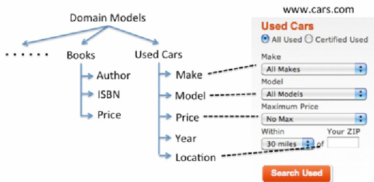
Рис. 2.2. Зіставлення між моделями предметної області та вхідними даними форми можна використовувати для автоматичного заповнення HTML-форм
