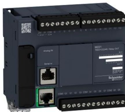
Рисунок 3.10 – ПЛК (PLC) Schneider Electric Modicon M221
