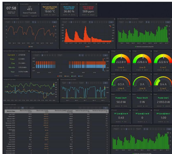
Рисунок 3.11 – Приклад інформаційної панелі системи енергомоніторингу та моніторингу роботи ФЕС на базі платформи smart-MAIC
