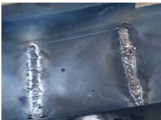
Рисунок 2.5. Якість швів MIG/MAG-зварювання, MIG-паяння
