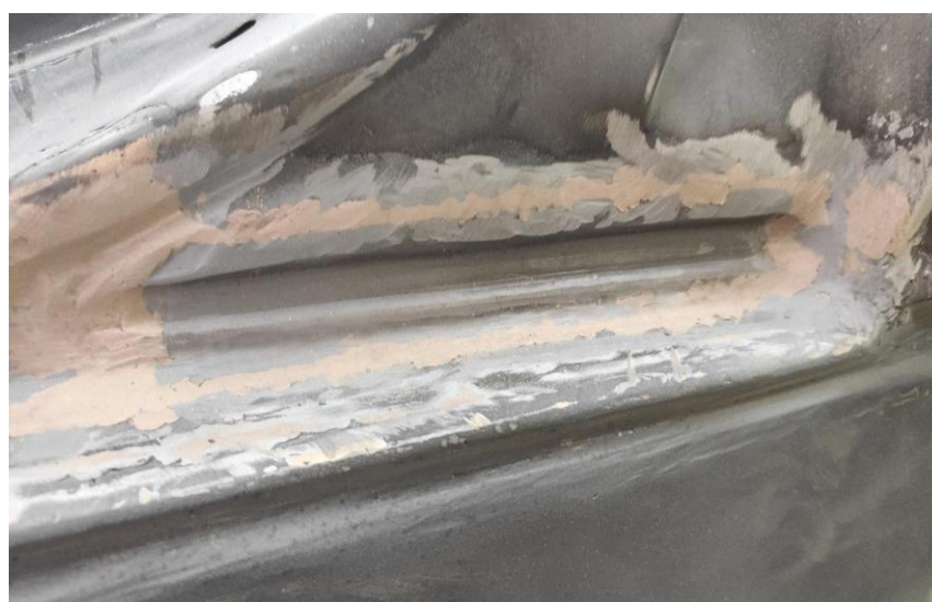
Рисунок 3.7. Якість шва виконаний методом MIG-паяння
