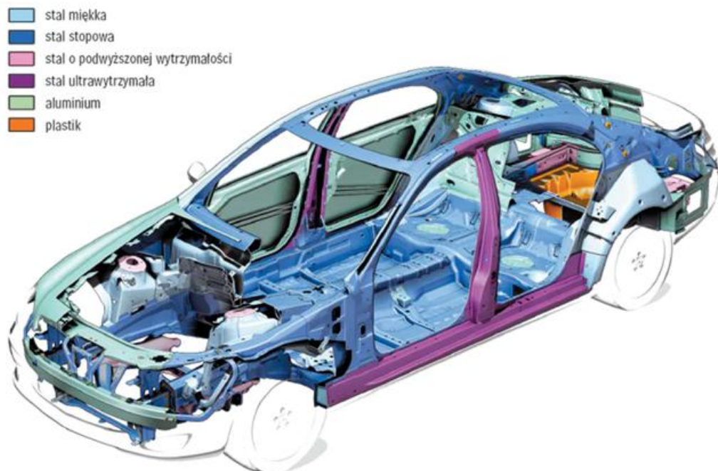
Рисунок 2.1. Схема кузова автомобіля за типом матеріалу виготовлення
