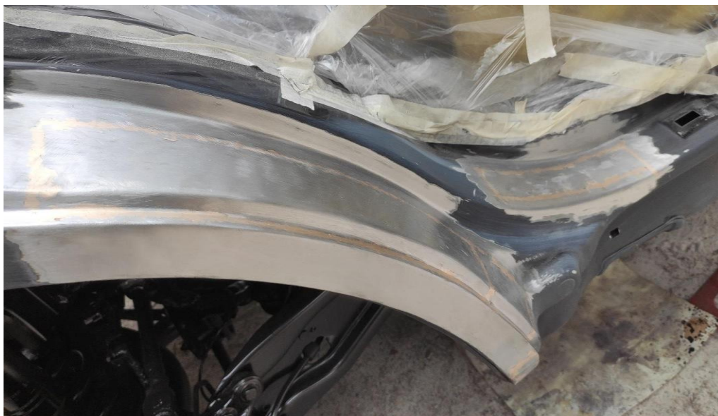
Рисунок 3.6. Приклад використання методу MIG-паяння при ремонті кузовного елемента
