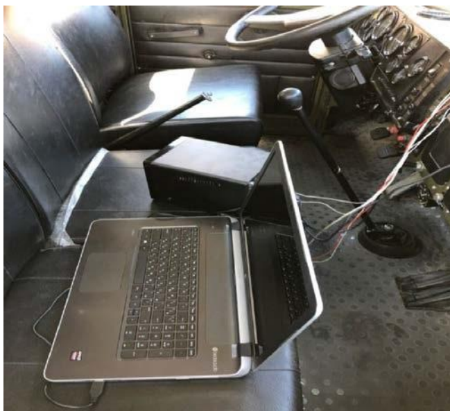
Рисунок 3.6 – Розміщення контрольно-вимірювального комплексу в кабіні НГТТ на шасі КрАЗ-6322
