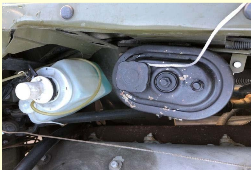
Рисунок 11.3 – Місце вимірювання температури робочої рідини в бачку насоса КрАЗ-6322
