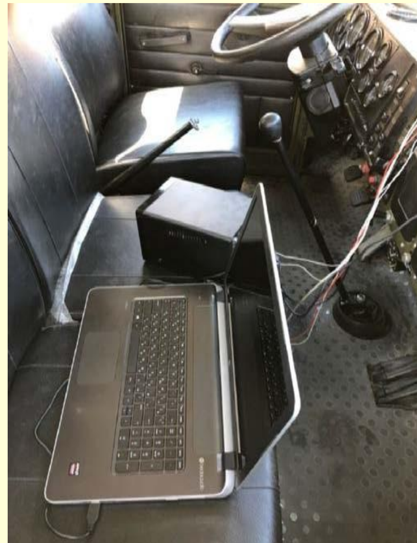
Рисунок 10.2 – Розміщення контрольно-вимірювального комплексу в кабіні агрегату для поточного та капітального ремонту свердловин УПА-50 на шасі КрАЗ-6322
