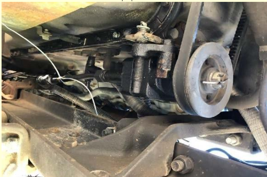
Рисунок 11.1 – Місце під'єднання термопар до трубопроводу масляного насоса на шасі КрАЗ-6322
