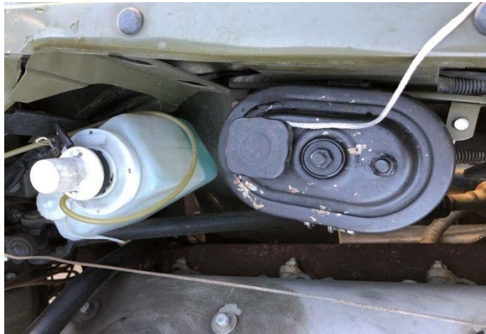
Рисунок 3.5 – Місце вимірювання температури робочої рідини в бачку насоса КрАЗ-6322
