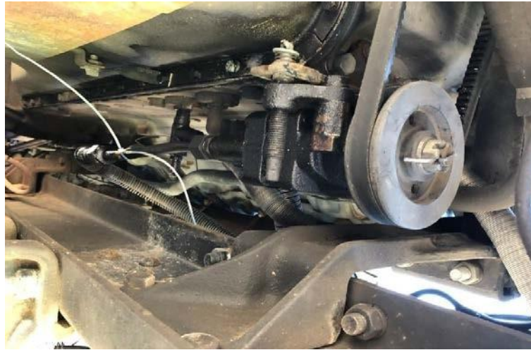
Рисунок 3.3 – Місце під'єднання термопар до трубопроводу масляного насоса на шасі КрАЗ-6322
