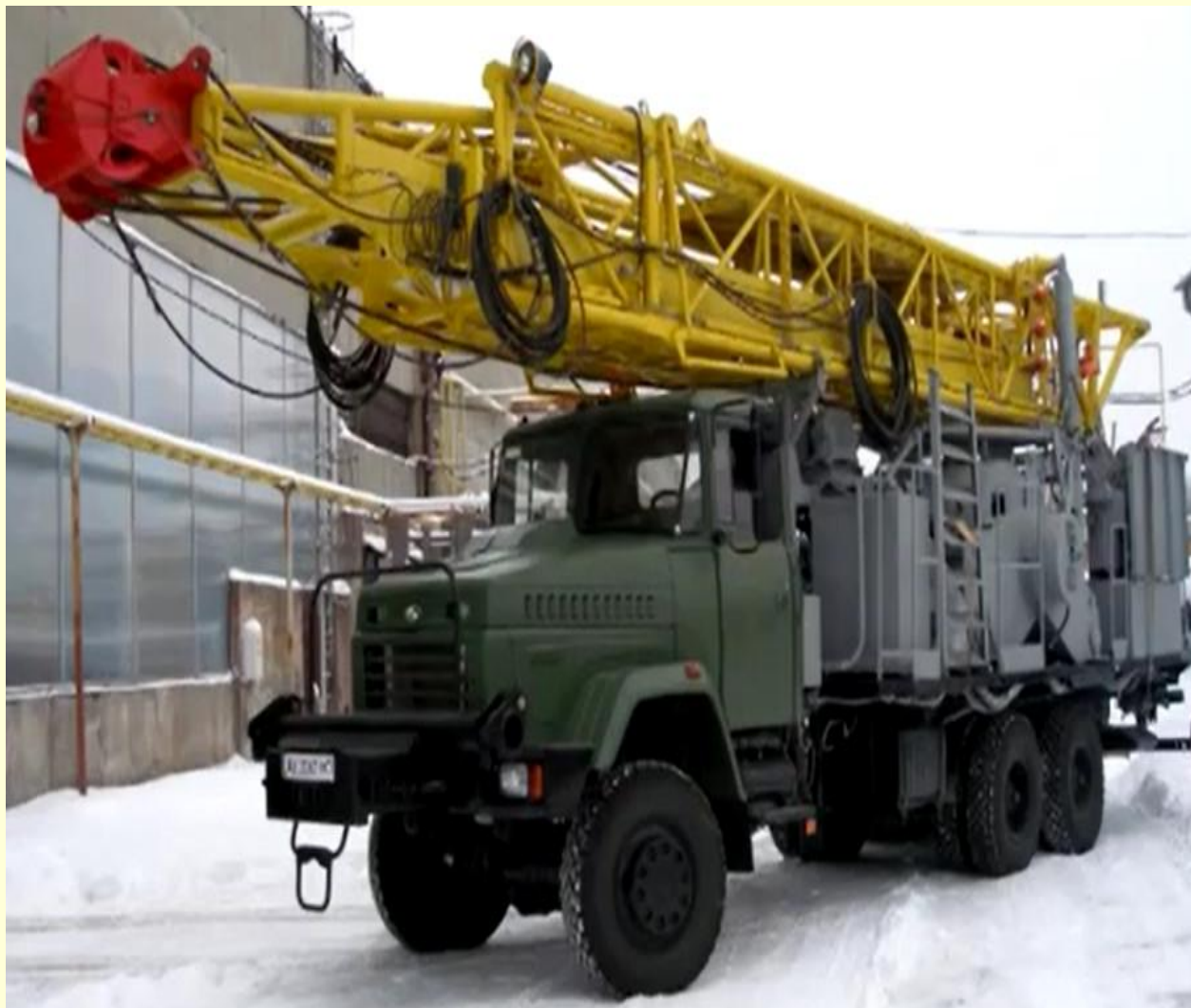
Рисунок 10.1 – Загальний вигляд випробуваного агрегату для поточного та капітального ремонту свердловин УПА-50 на шасі КрАЗ-6322
