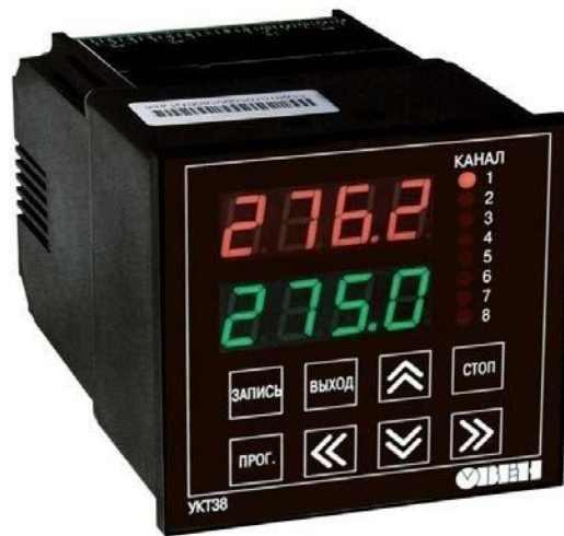
Рисунок 3.2 – Контрольно-вимірювальний комплекс УКТ38
