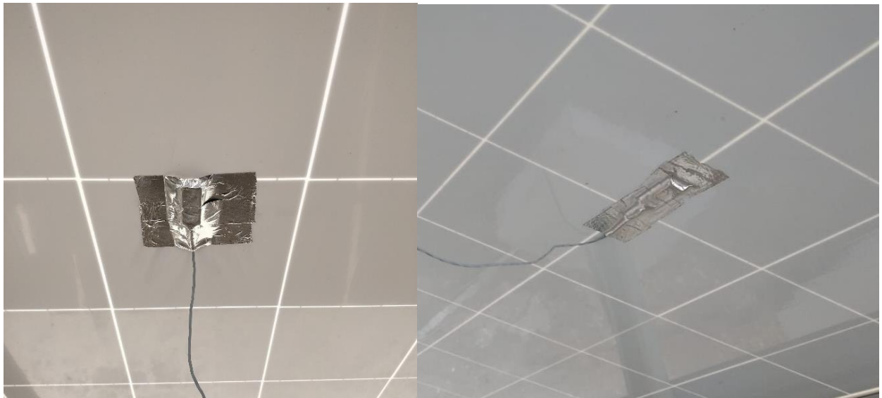
Рисунок 17 – приклад кріплення давача температури фотоелектричного модуля[21]
