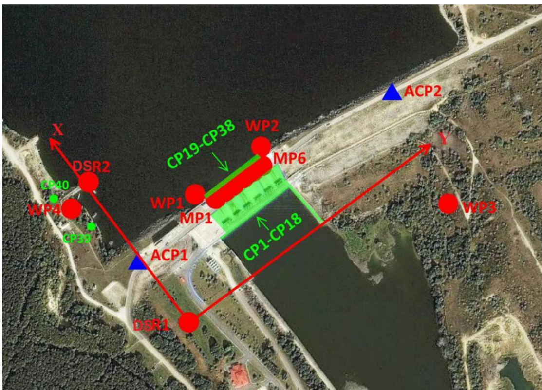
Рисунок 1.2 – Схема мережі геодезичних пунктів ССМПЗС Дністровської ГЕС-1
