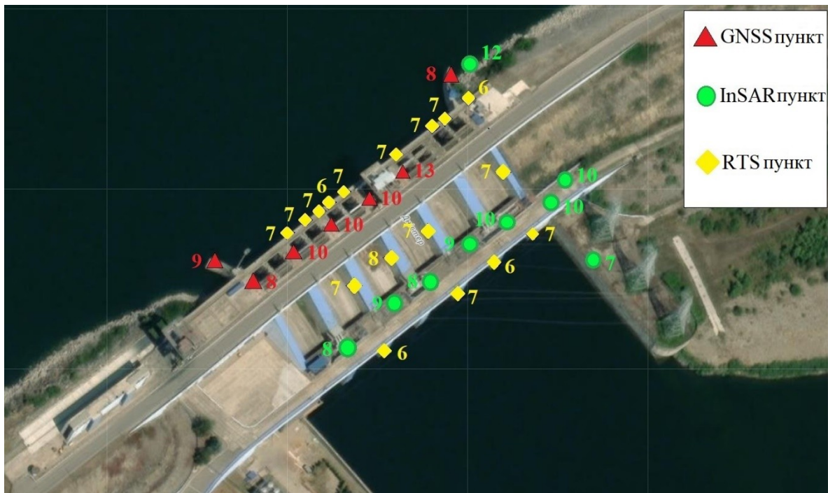
Рисунок 3.9 – Просторовий розподіл амплітуд вертикальних зміщень контрольних точок бетонної греблі визначених методами GNSS, RTS, InSAR (мм)
