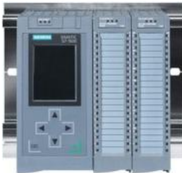
Рис. 3.1. ПЛК Siemens S7-1500
