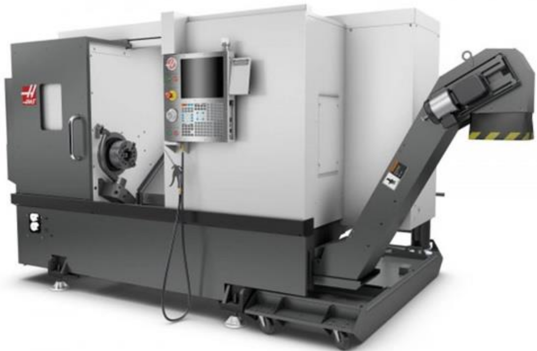
Рис. 1.6 –Токарний верстат з ЧПК мод.НААС ST 25
