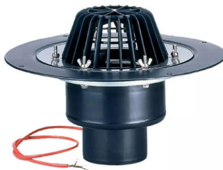
Рис. 5.15. Загальний вигляд покрівельної воронки HL Ø110 мм з затискним елементом і підігрівом (10-30 Вт/230 В). (HL62.1/1)
