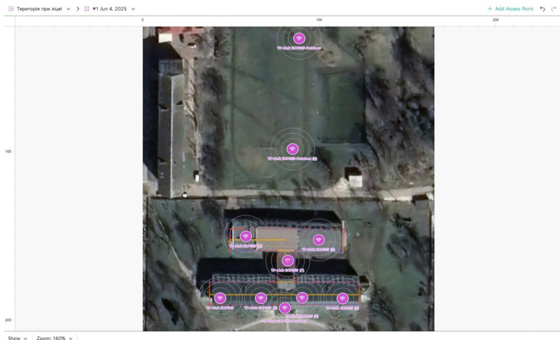
Рисунок 3.12 – Розміщення зовнішніх точок доступу на території ліцею (моделювання в NetSpot)
