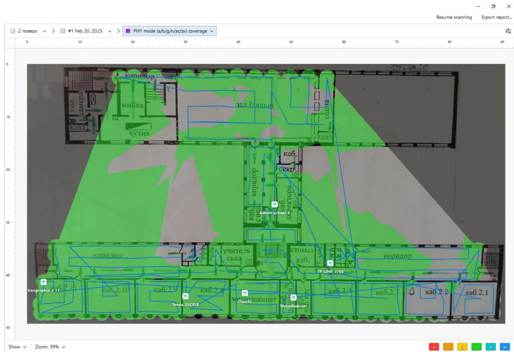
Рисунок А.15 – PHY mode (a/b/g/n/ac/ax) coverage (2 поверх)
