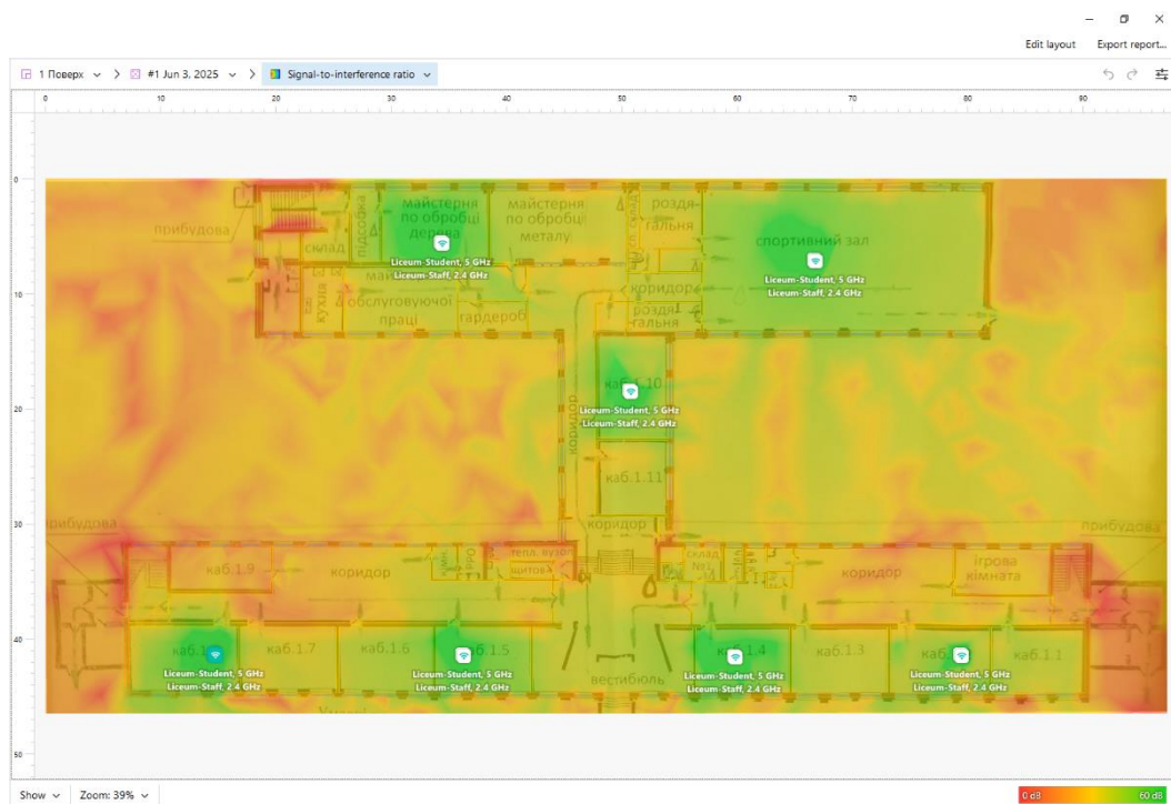
Рисунок Б.2 – Signal-to-interference ratio (1 поверх)
