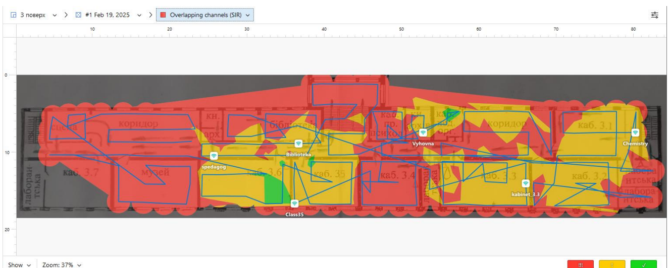
Рисунок 2.9 – Карта перекриття каналів
