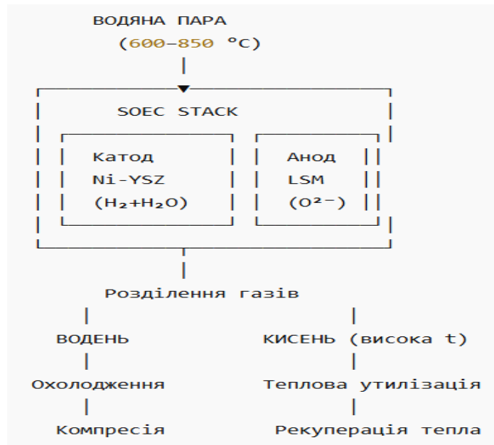
Рис.1.5. Твердотільний електролізер (SOEC - Solid Oxide Electrolysis Cell)
