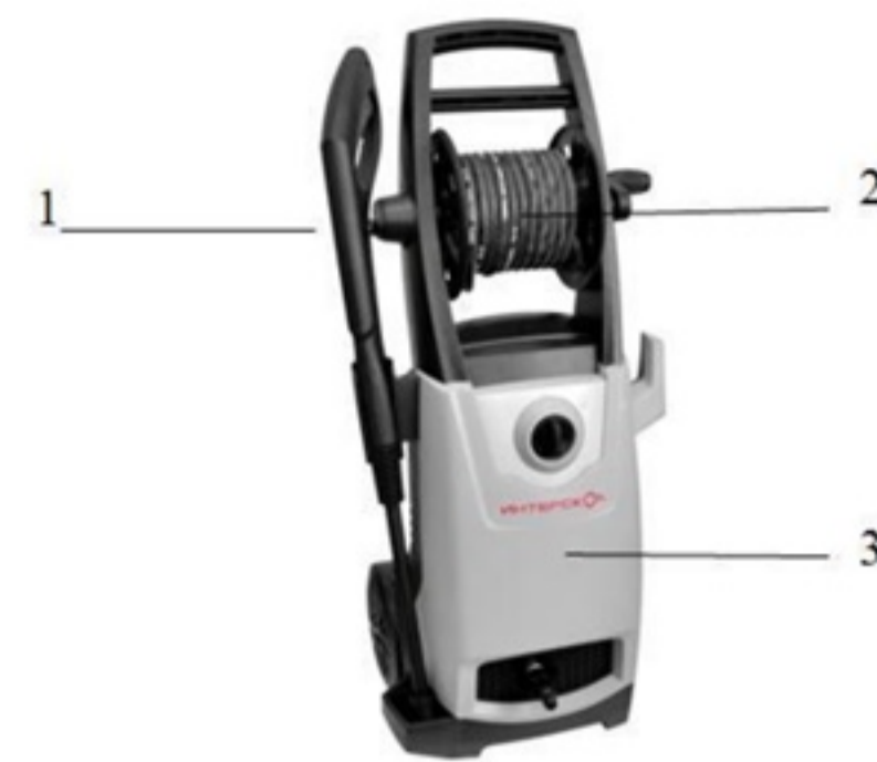
1 – гідромонітор; 2 – шланг високого тиску; 3 – захисний кожух силової установки
