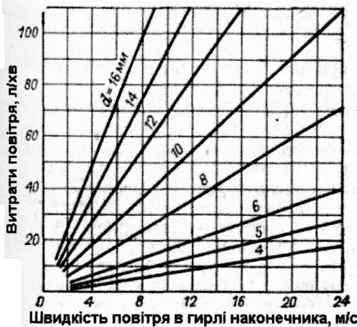
Рисунок 2.10 - Графік для підбору діаметра кінцевика ( d ) пило забірної трубки
