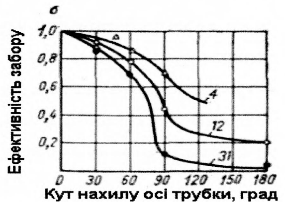
Рисунок 2.11 - Відхилення заміряного пиловмісту від фактичного: а - при різних співвідношеннях між швидкістю потоку в газоході і в забірній трубці; б - при різних кутах нахилу осі трубки до напрямку потоку (цифри на кривих — діаметр частинок, 10^{-6} м).
