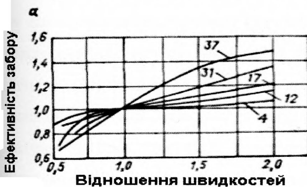
Рисунок 2.11 - Відхилення заміряного пиловмісту від фактичного: а - при різних співвідношеннях між швидкістю потоку в газоході і в забірній трубці; б - при різних кутах нахилу осі трубки до напрямку потоку (цифри на кривих — діаметр частинок, 10^{-6} м).
