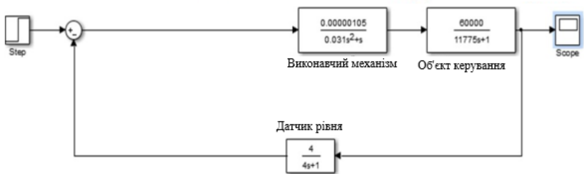
Рис. 2.10. Схема моделювання замкненої системи
