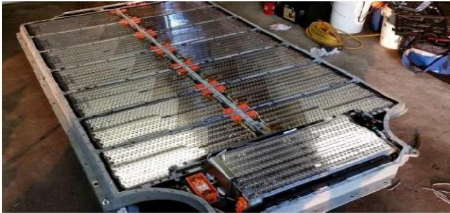
Рис.17.2. Літій-іонна акумуляторна батарея електромобіля Nissan Leaf
