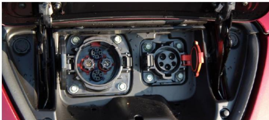
Рис.5.5. Роз'єми електромобіля Nissan Leaf
