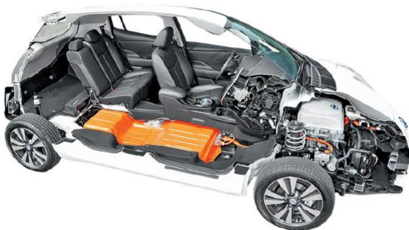
Рис.5.4. Розміщення літій-іонної акумуляторної батареї в електромобілі Nissan Leaf
