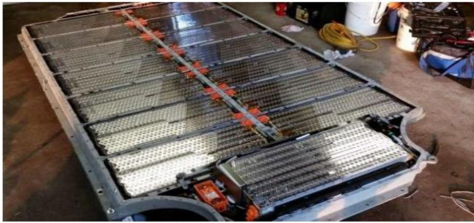
Рис.5.3. Літій-іонна акумуляторна батарея електромобіля Nissan Leaf
