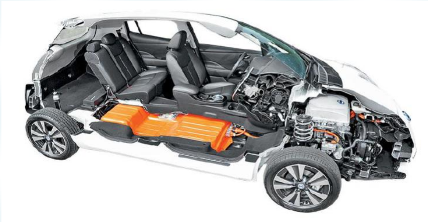
Рис.17.1. Розміщення літій-іонної акумуляторної батареї в електромобілі Nissan Leaf
