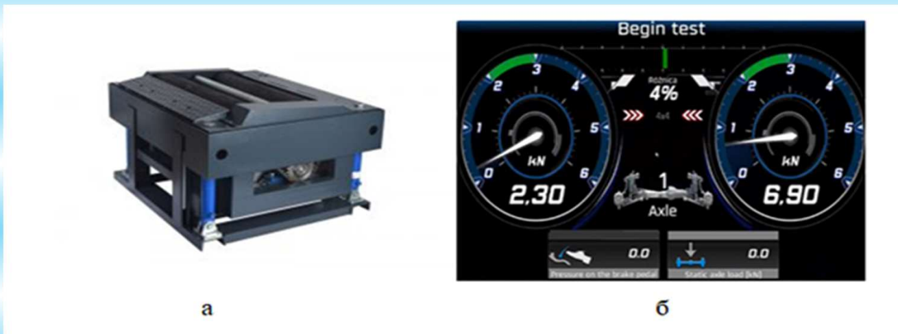
Стенд гальмівних властивостей Unimetal ALPHA RBT-5300: а – загальний вигляд стенда; б - Інтерфейс Unimetal ALPHA RBT-5300.
