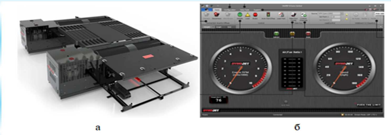
Стенд тягово-економічних властивостей Dyno Jet 424xLC2: а – загальний вигляд стенда; б - Інтерфейс Dyno Jet 424xLC2.
