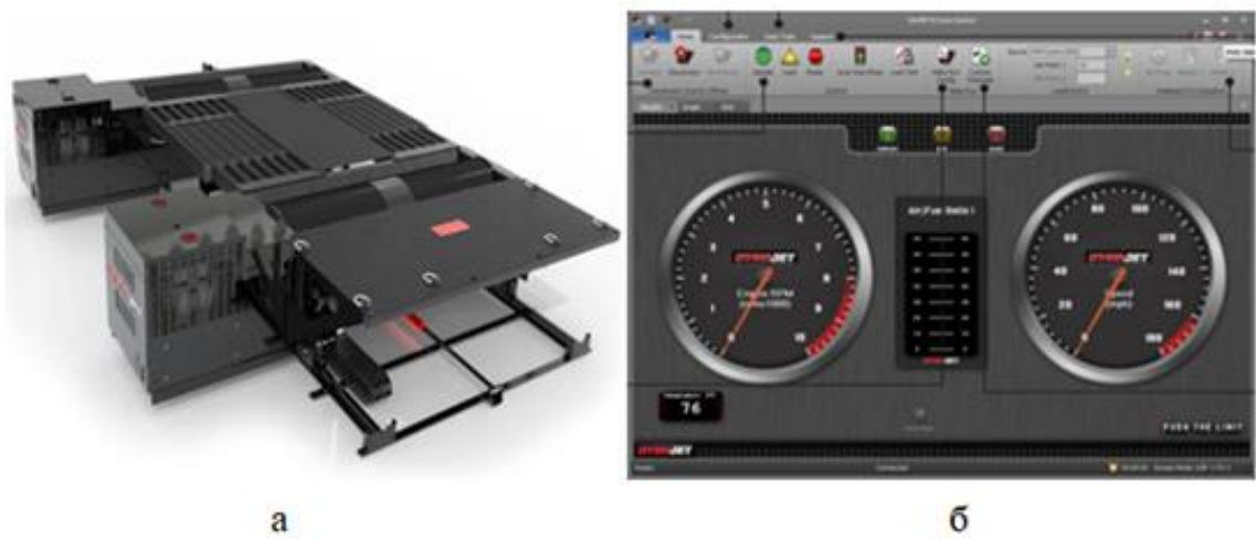
Рисунок 4.1 – Стенд тягово-економічних властивостей Dyno Jet 424xLC 2 : а – загальний вигляд стенда; б – інтерфейс Dyno Jet 424xLC 2 .
