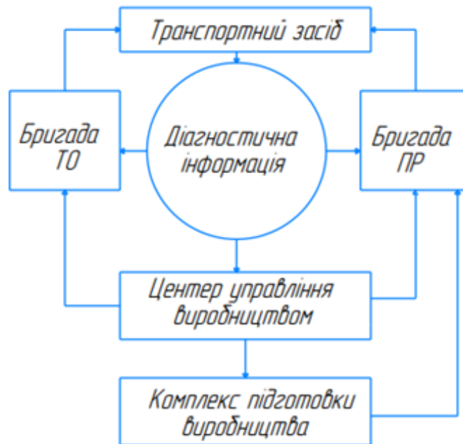
Рисунок 3.2 – Схема використання діагностичної інформації на АТП
