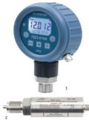
Рисунок 2.10 - Перетворювач тиску еталонний ПДЕ-010:
