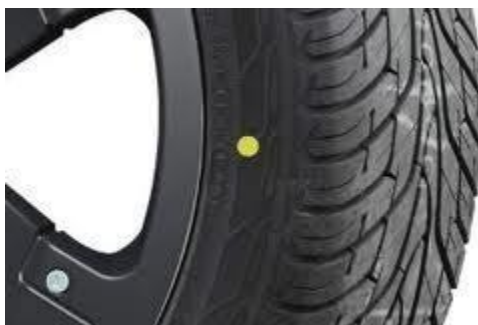
Рисунок 1.13 – Маркування найлегшої та найважчої зон автомобільної шини.
