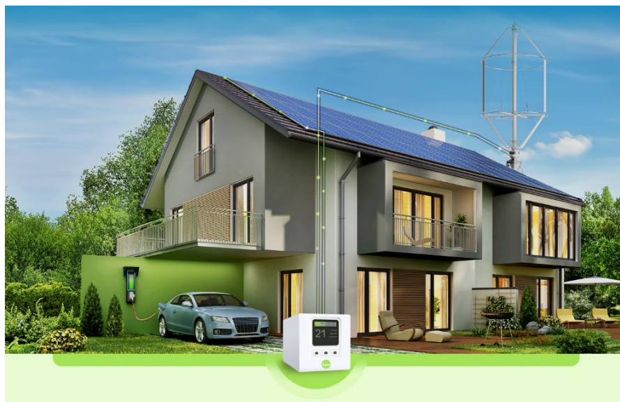
Рисунок 2.1 - Ілюстрація житлового будинку із установкою перетворення сонячної енергії та з накопичувачем енергії (інвертор 5 кВт, акумулятор ~ 10 кВт·год) з фотоелектричною системою на даху та невеликою вітровою турбіною [47].
