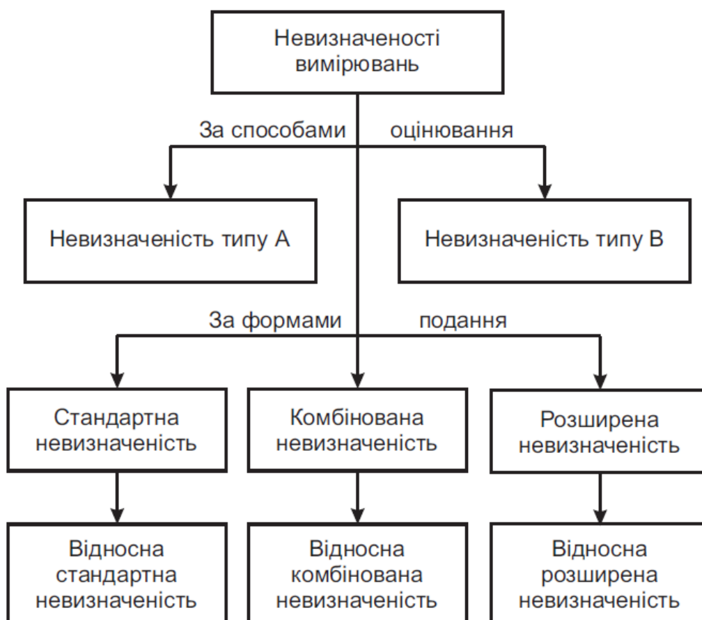
Рисунок 4.1 – Систематизація невизначеностей вимірювання
