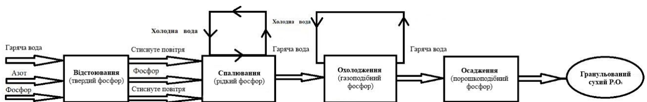
Рис. 3.1. Етапи одержання сухого P 2 O 5
