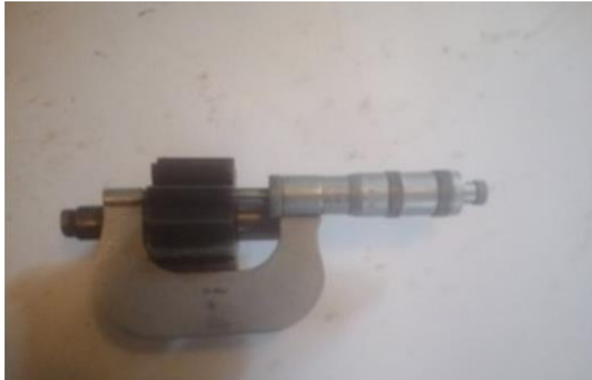
Рисунок 3.1 – Методика замірювання висоти шестерні
