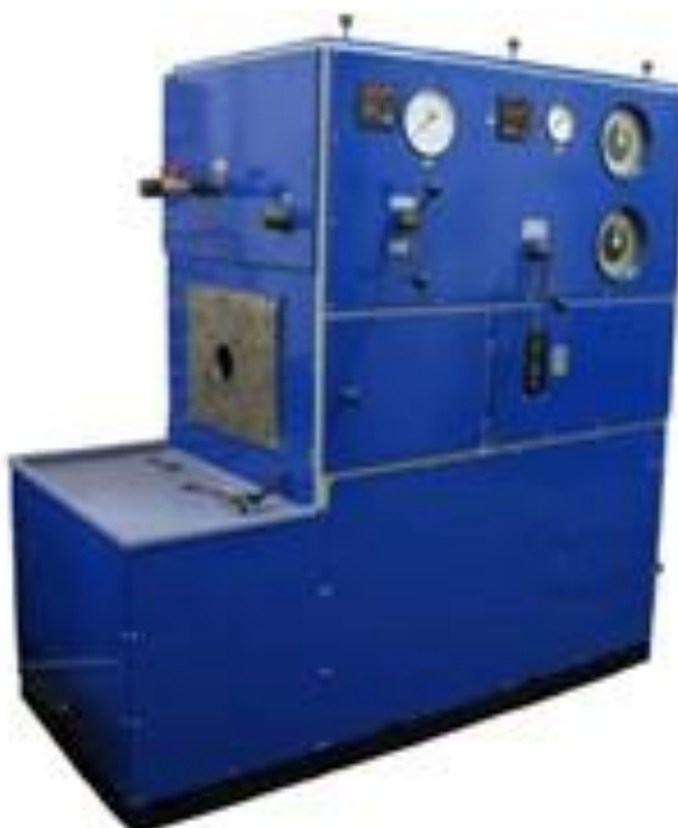
Рисунок 3.4 – Загальний вид стенда КИ-5278 для обкатки та випробовування вузлів системи мащення двигунів внутрішнього згорання
