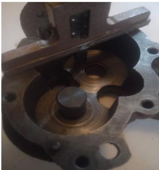
Рисунок 3.3 – Замірювання колодязя корпуса насоса по висоті
