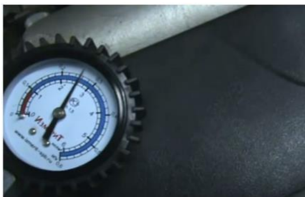
Рис.2.6. Знижений тиск палива в рампі
