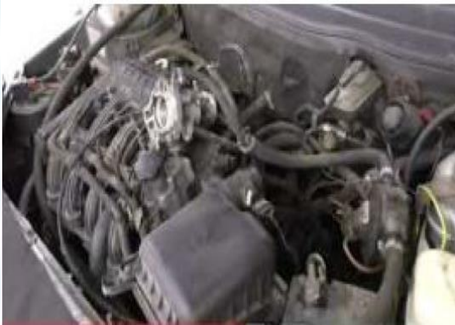
Рис. 10.1. Система інжекційного впорскування палива автомобіля Хюндай Акцент
