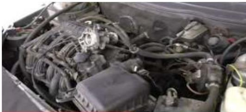
Рис. 2.1. Система інжекційного впорскування палива автомобіля Хюндай Акцент
