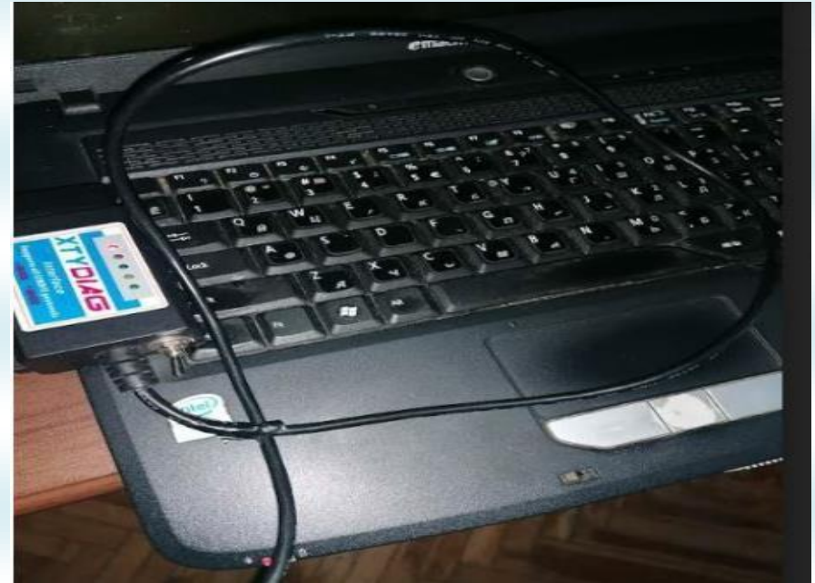
Рис. 10.2. Апаратура для комп'ютерної перевірки паливної системи бензинового двигуна автомобіля Хюндай Акцент
