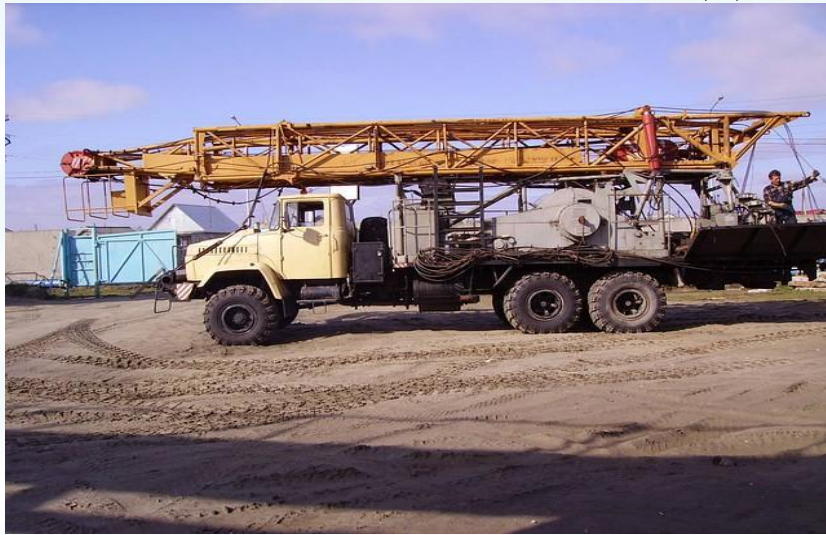
Рисунок 10.1 – Експериментальна установка АОРС-60 на базі автомобіля КрАЗ-260 із встановленими датчиками контролю температури амортизаторної рідини і температури навколишнього повітря
