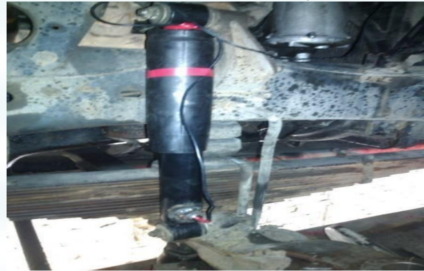
Рисунок 10.1 – Експериментальна установка АОРС-60 на базі автомобіля КрАЗ-260 із встановленими датчиками контролю температури амортизаторної рідини і температури навколишнього повітря
