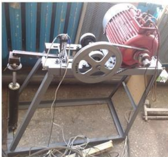
Рисунок 3.2 – Промислова експериментальна установка для визначення експлуатаційних характеристик амортизаторів
