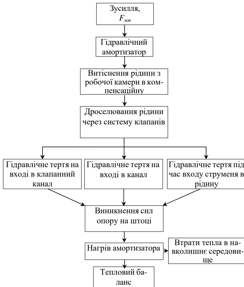
Рисунок 2.4 – Взаємозв'язок процесів, що виникають у результаті перетворення механічною енергії в теплову під час роботи гідравлічного амортизатора
