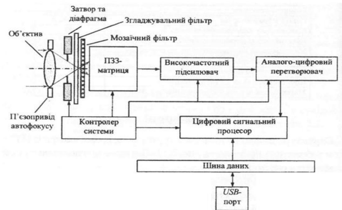
Рис. 3.9. Структурна схема цифрового фотоапарату із ПЗЗ-давачем
