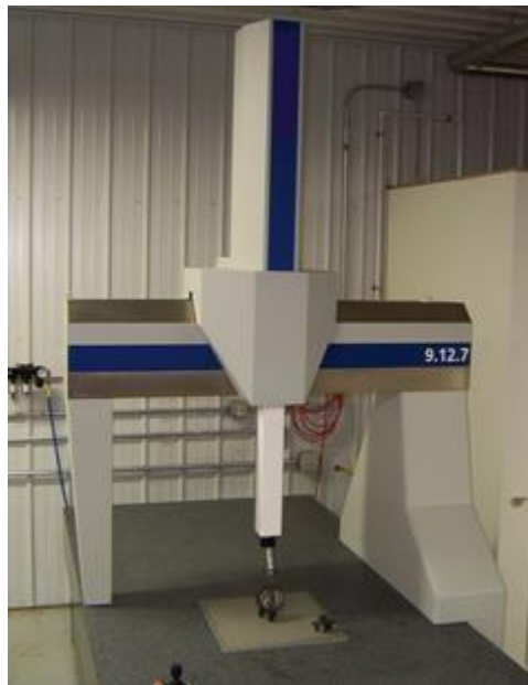
Рисунок 1.1 – Координатно-вимiрювальна машина iз двома фiксованими взаємно перпендикулярними вимiрювальними руками
