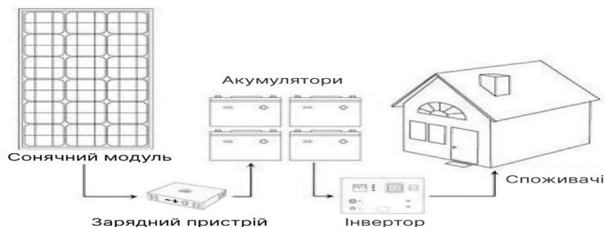
Рисунок 1.1 – Схема типової сонячної електростанції [2].
