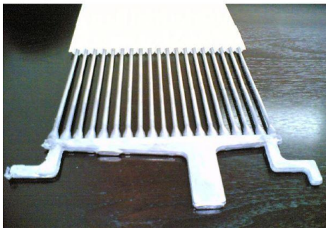
Рисунок 9 – Сучасна трубчаста позитивна пластина для батарей Tubular OPzV/OPzS
