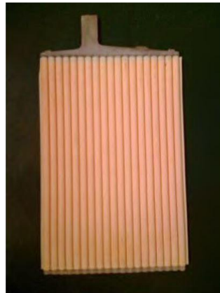
Рисунок 9 – Сучасна трубчаста позитивна пластина для батарей Tubular OPzV/OPzS
