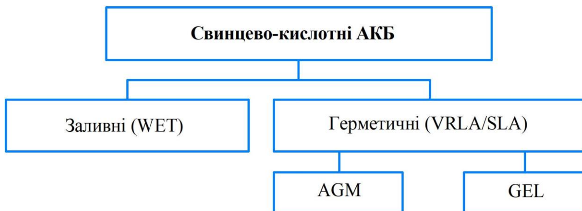
Рисунок 4.1 – Загальна класифікація свинцево-кислотних АКБ
