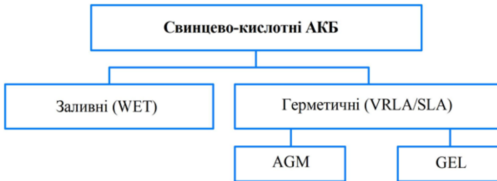
Рисунок 4 – Загальна класифікація свинцево-кислотних АКБ
