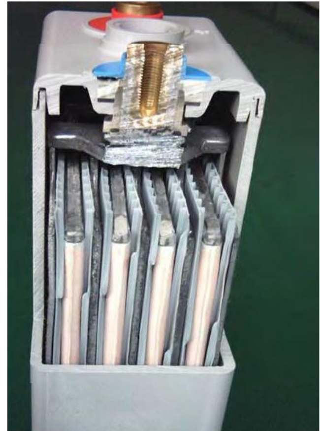
Рисунок 10 – Трубка з бічним захистом для запобігання коротких замикань через тертя в GEL акумуляторах
