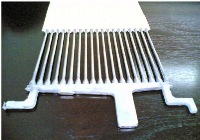
Рисунок 4.6 – Сучасна трубчаста позитивна пластина для батарей Tubular OPzV/OPzS
