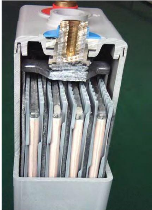
Рисунок 4.7 – Трубка з бічним захистом для запобігання коротких замикань через тертя в GEL акумуляторах
