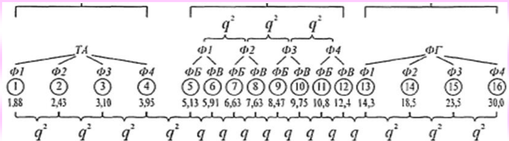
Рисунок 8.1. Графіки зміни швидкості нафтогазової установки V залежно від передачі, що включається, коефіцієнта перекриття q і перепадів швидкостей \Delta V між суміжними передачами від номера перемикання передач
