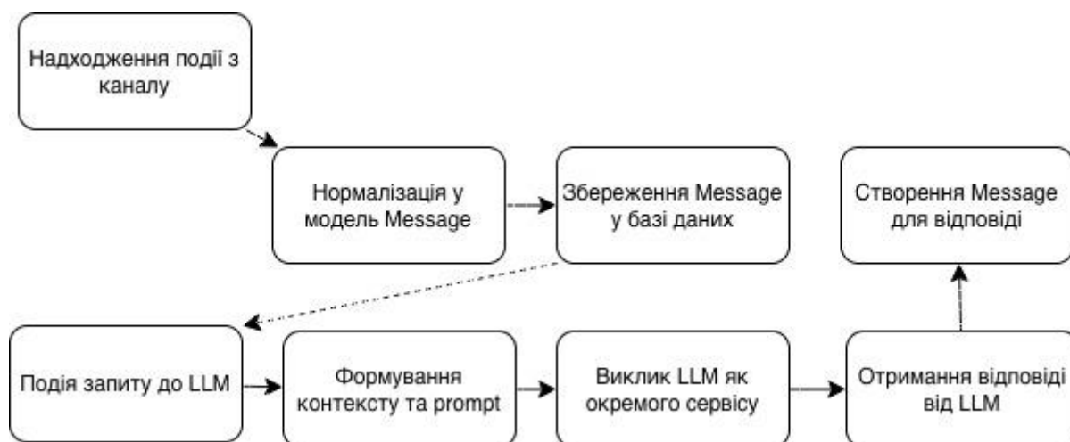
Рис. 3.12. Включення LLM у подієвий конвеєр Message
