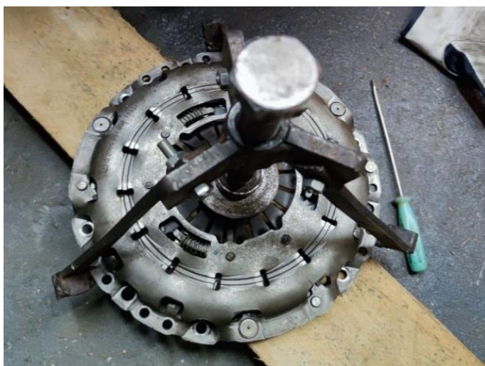
Рисунок 3.10 - Відновлення механізму саморегулювання натискного диска механічної коробки передач у початкове положення.
