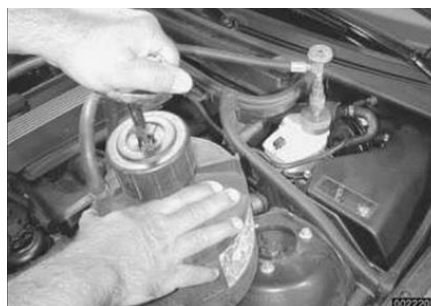
Рисунок 7 - Пристрій для прокачування гальмівної системи під тиском (R. Bentley (2006) BMW 3 series service manual 1999-2005)
