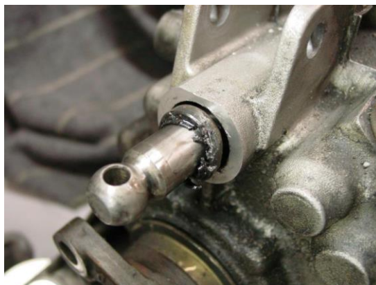
Рисунок 3.5 - Виймання сальника валу перемикавання передач
