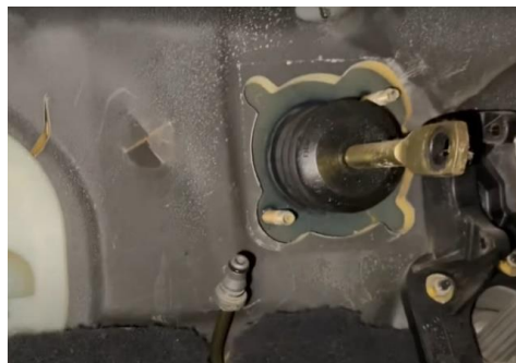
Рисунок 3.8 - Прокладання шланга системи керування зчепленням до бачка гальмівної рідини.
