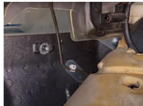
Рисунок 21 - Прокладання шланга системи керування зчепленням під килимовим покриттям
