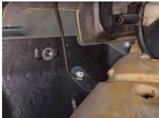
Рисунок 3.7 - Прокладання шланга системи керування зчепленням під килимовим покриттям
