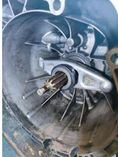
Рисунок 3.6 - Вилка вимикання зчеплення та вижимний підшипник механічної коробки передач, правильно встановлені на первинному валу
