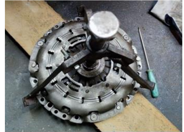
Рисунок 24 - Відновлення механізму саморегулювання натискного диска механічної коробки передач у початкове положення
