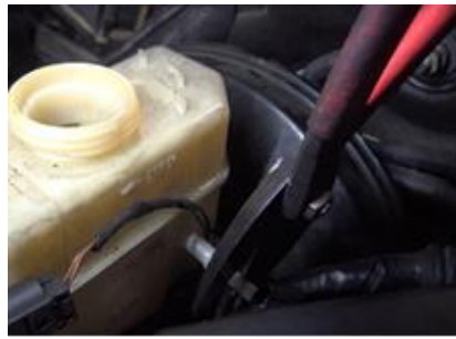
Рисунок 23 - Відкриття отвору в бачку гальмівної рідини шляхом зрізання заглушки
