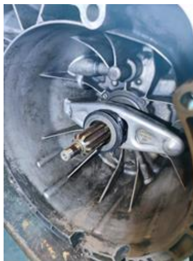
Рисунок 20 - Вилка вимикання зчеплення та вижимний підшипник механічної коробки передач, правильно встановлені на первинному валу
