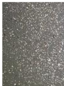
Рисунок 3.1 - Металеві відкладення у трансмісійному мастилі.
