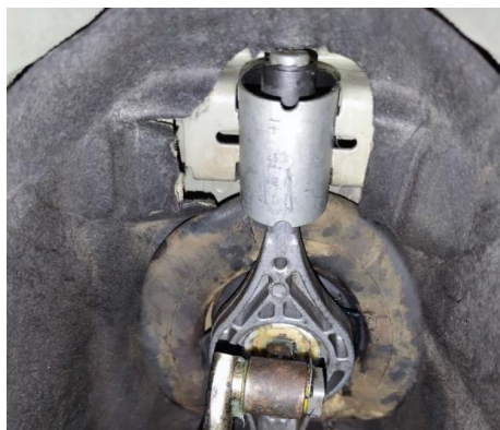
Рисунок 3.12 - Запресована втулка опори важеля перемикавання передач механічної коробки передач.
