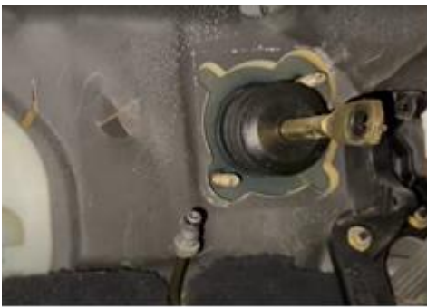
Рисунок 22 - Прокладання шланга системи керування зчепленням до бачка гальмівної рідини
