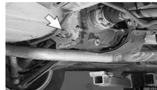
Рисунок 8 - Заливний отвір оливи диференціала BMW E46 (R. Bentley (2006) BMW 3 series service manual 1999-2005)
