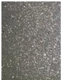
Рисунок 15 - Металеві відкладення у трансмісійному мастилі
