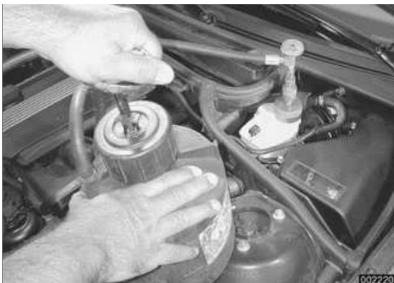
Рисунок 1.10 - Пристрій для прокачування гальмівної системи під тиском
