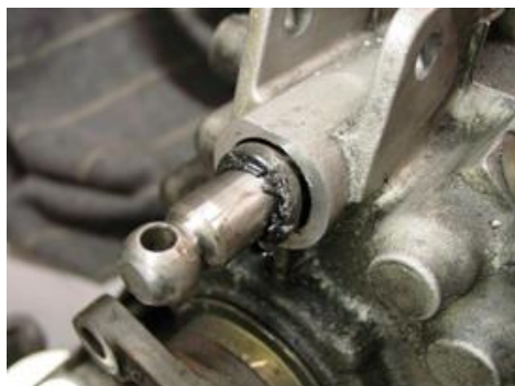
Рисунок 19 - Виймання сальника валу перемикавання передач
