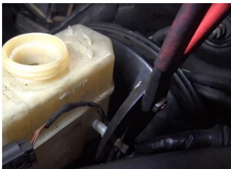
Рисунок 3.9 - Відкриття отвору в бачку гальмівної рідини шляхом зрізання заглушки.
