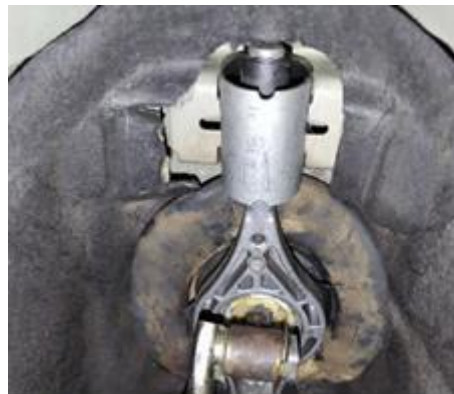
Рисунок 26 - Запресована втулка опори важеля перемикавання передач механічної коробки передач
